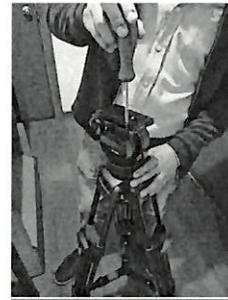
Ajuste de tornillos tipo "torx" de cabezal de trípode.
