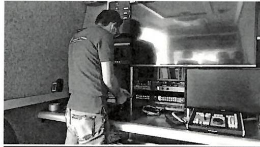
Limpieza de multiview y ajuste de tornillería de los rack's
