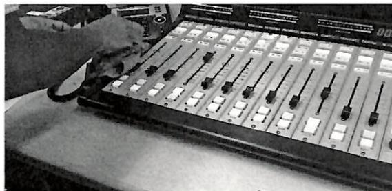
Se elimina el polvo, en los fader's y se ajustan niveles de audio.
